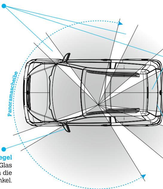
**Sicht nach Hinten.** Eine erweiterte Sicht nach Hinten ermöglicht es Hindernisse schnell auszumachen und diese sicher zu umfahren.
