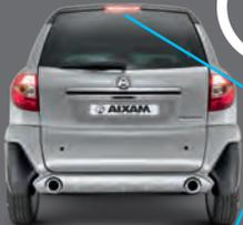
Dank der LED-Technologie, leuchtet die Dritte Bremsleuchte 10-mal schneller auf als eine herkömmliche Glühbirne.
